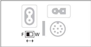
Der POSITION-Schalter befindet sich am Lautsprecher-Anschlussfeld.
