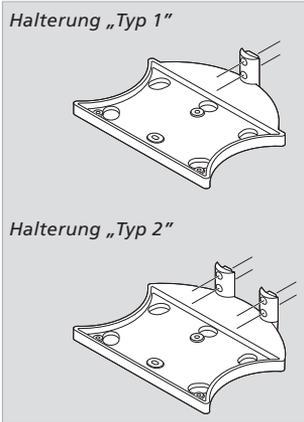
**BeoLab 7-Halterungen:** Der Lautsprecher muss an einer der hier gezeigten Halterungen und an einem geeigneten Bang & Olufsen Standfuß bzw. einer Wandhalterung befestigt werden.
